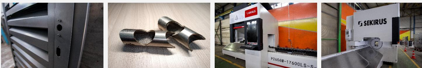
3. Часть заготовок производится из листового металла с помощью станка лазерной резки и листогибочного станка с ЧПУ
