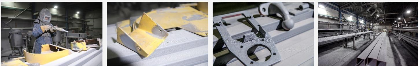
2. Нарезка труб и подготовка отверстий под замки и ручки производится на лазерном станке. Это позволяет выдерживать высокую точность в размерах.
