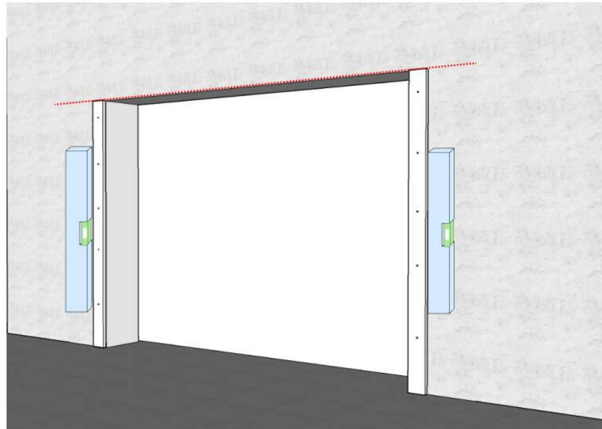
4. Прикрепите направляющие к стене. Соблюдайте осторожность при установке и проверяйте уровнем вертикаль и горизонталь
