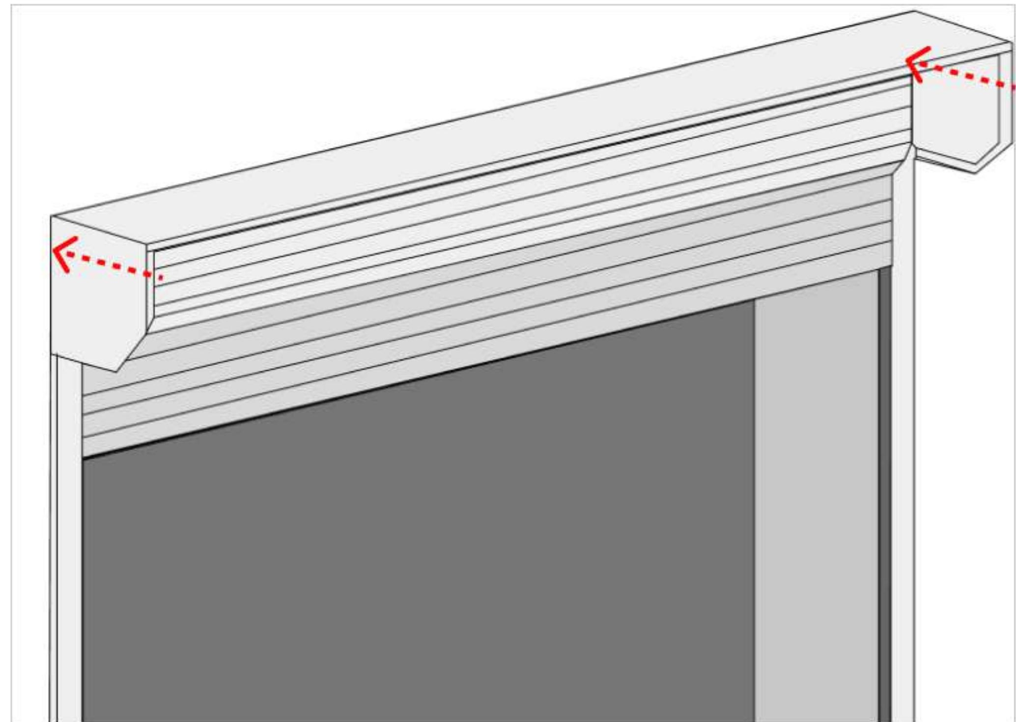
6. Снимите нижнюю крышку короба и закрепите боковые заглушки в верхней части соответствующими дюбелями/винтами
